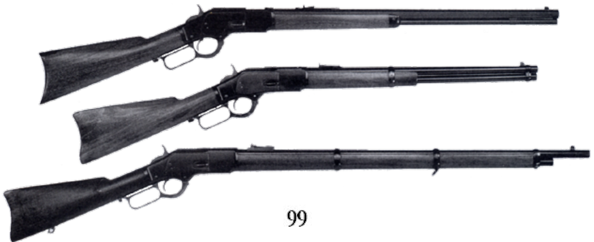
Dessin 99 : carabine et fusils WINCHESTER modèle 1873 en calibre .44/40 ( également en 32/20 et 38/40 ).
